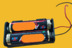
Dudukan baterai dan baterai AA 1,5 Volt Fungsi: Sumber Tegangan
