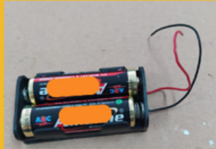
Dudukan baterai dan baterai AA 1,5 Volt Fungsi: Sumber Tegangan
