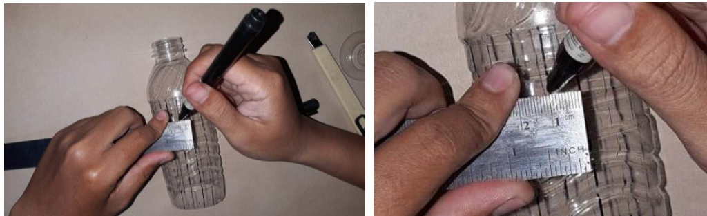
Gambar 8.25 Membuat garis bantu potong selebar 1 cm secara melingkar
