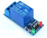
Gambar 4.9 Relay (Saklar Elektrik)
