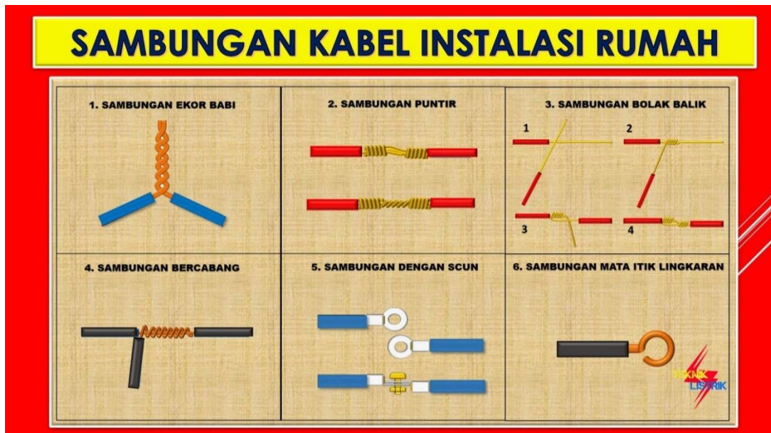
Gambar 2.11 Sambungan Kabel Listrik
