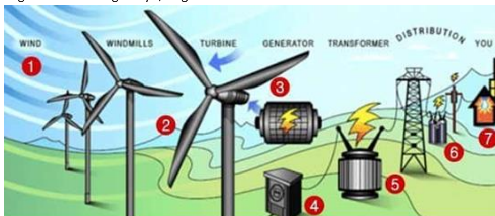
Gambar 1.9 Skema Cara Kerja PLTB
