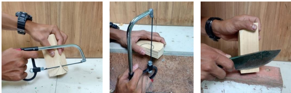
Gambar 1. 10. Proses Membentuk Burung Hantu dan Gajah dengan Gergaji dan Pisau Pangot Sumber: Dokumen Martono, 2020
