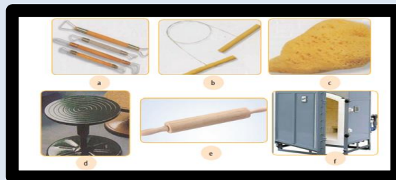
Gambar 1.8 Alat Produksi Kerajinan Gerabah a. butsir, b. tali pemotong, c. spon, d. handwheel , e. rol, f. tungku pembakaran Sumber: Suci Prasetya, dkk (2016)
