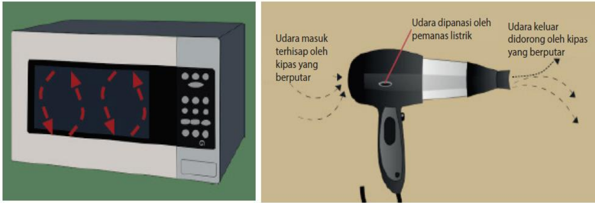
Gambar 4.18. Pemanfaatan perpindahan kalor secara konveksi pada bidang teknologi (Oven dan Pengering Rambut) Sumber: Dok. Kemdikbud
