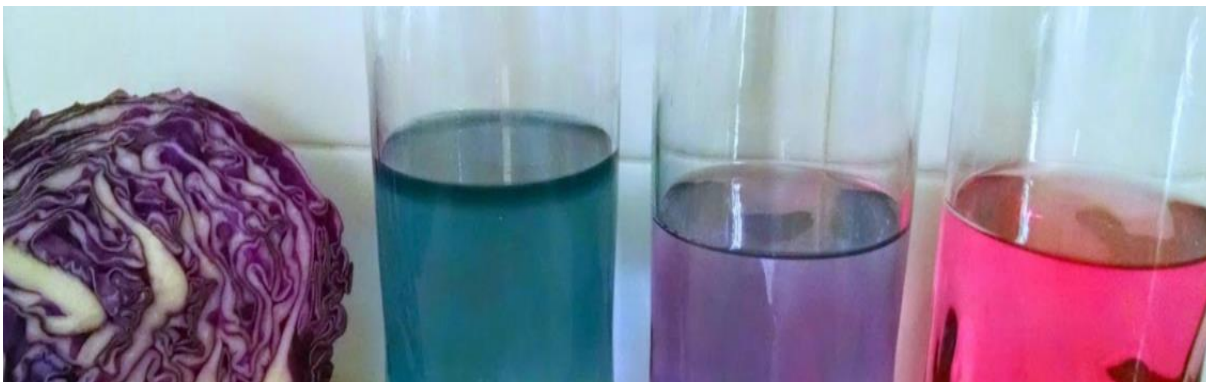
Gambar 3.8. Percobaan Indikator Alami menggunakan ekstrak kubis ungu. Gelas sebelah kiri gelas sudah ditetesi sabun, gelas tengah tidak ditetesi apapun, gelas bagian kanan gelas sudah ditetesi cuka. Sumber: sciencekiddo.com
