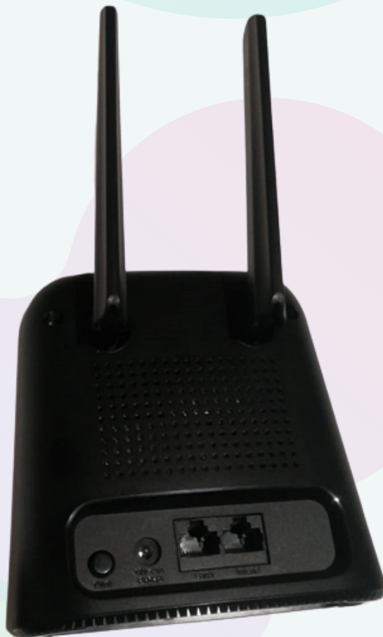
Gambar 1. Dua antenna terpasang pada wireless router
