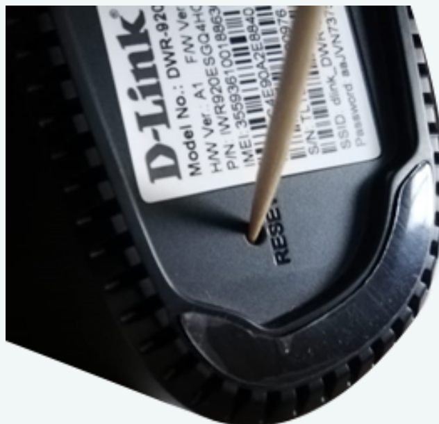
Gambar 48. Menekan tombol reset dengan alat bantu
