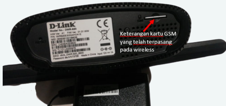
Gambar 2. Kartu GSM terpasang pada wireless router
