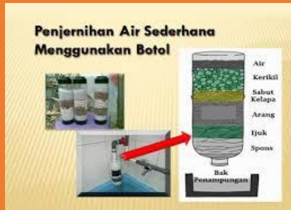
Gambar 6. Alat penjernih air sederhana
