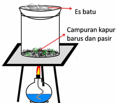
Gambar 6. Rangkaian Alat Sublimasi Sederhana
